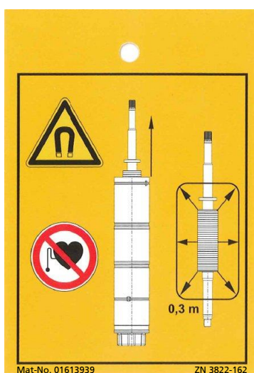
Рис. 2: Предупреждающая наклейка, которую нужно приклеивать на двигатель при возврате.
